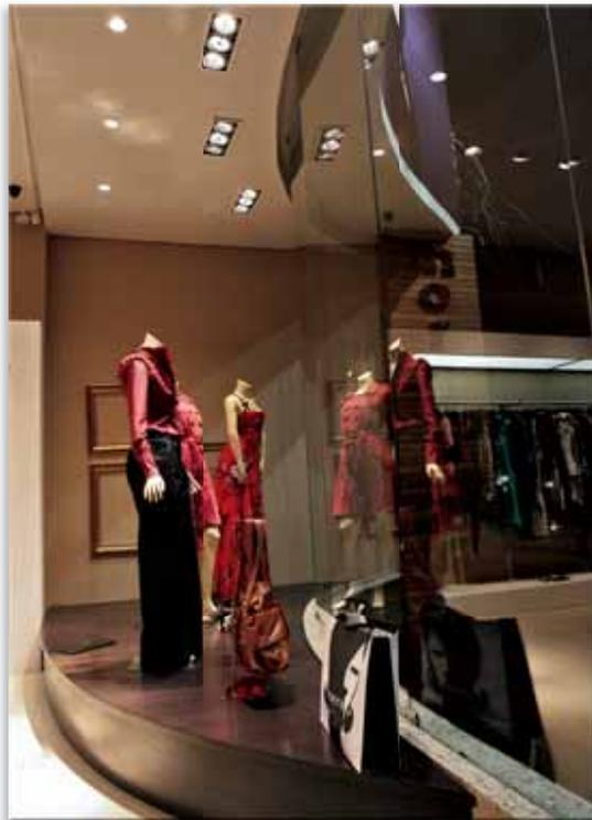
também destinado a acessórios, o lighting designer utilizou luminárias com filtro difusor translúcido para lâmpadas halógenas dicróicas dimerizáveis de 50W, com 40° de abertura e a 3100K.
